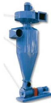
Wartungsarmer Niederdruck-Ventilator mit direkt gekoppeltem Gebläselauftrad
